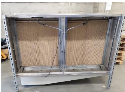
3.15 ábra a, beépített evaporatív hűtőfal b, a légszűrő rendszerbe beépített evaporatív léghűtő berendezések
