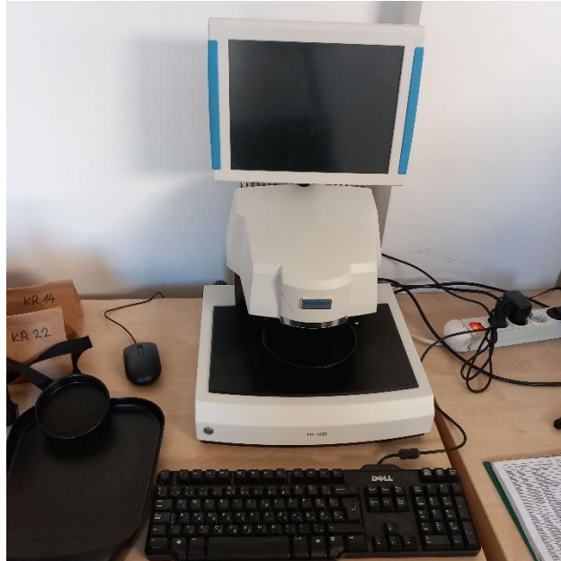
3. ábra: A kukoricaszemek beltartalmi paramétereinek vizsgálatára használt PerkinElmer DA 7250 típusú analitikai műszer (Nádudvar, 2023)
