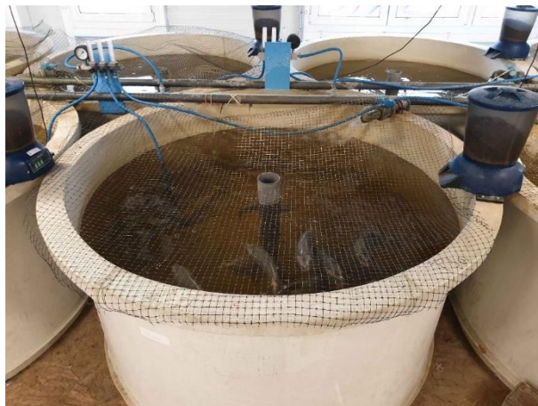
6. ábra: Az 1000 liter egységnyi hasznos víztérfogatú recirkulációs rendszer egyik körmedencéje, benne a monoszex ikrás állomány példányaival ( Saját felvétel )
