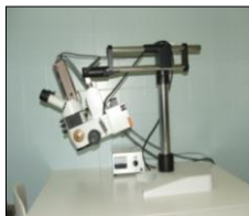
Leica Wild M650 oktató - gyakorló - kutató mikroszkóp
