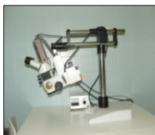
Leica Wild M650 oktató - gyakorló - kutató mikroszkóp
