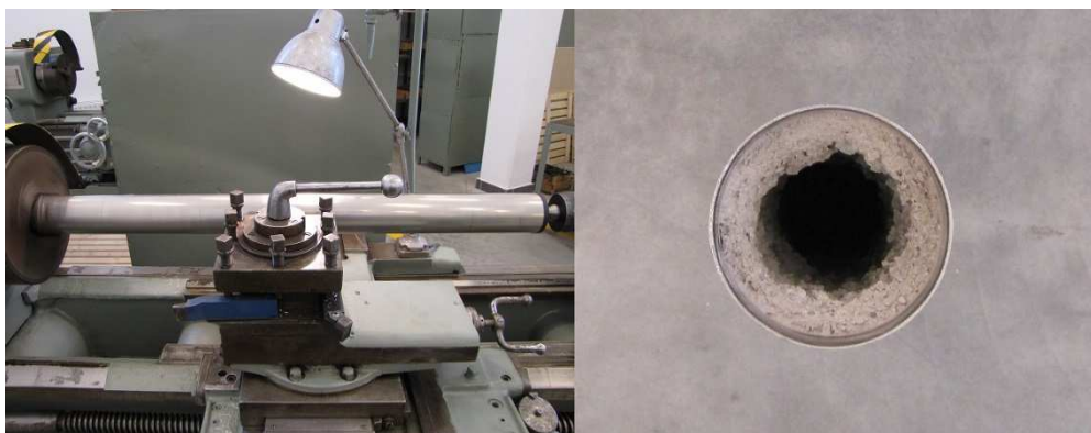
7. ábra A rozsdamentes acélcső az esztergapadon történő forgatás közben, valamint az első cementesztrich réteg felvitele utáni állapotban
