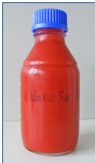
7. ábra: Nanoméretű elemi szeléngömböket tartalmazó NanoSel szol
