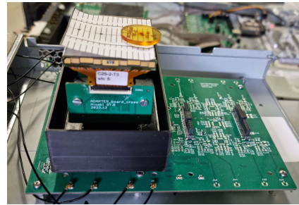
(a) Module with Cs-137 source;
