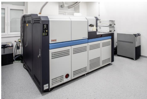
30. ábra: A Sr és Pb izotóparány mérésekre alkalmazott Neptune Plus MC-ICP-MS.
