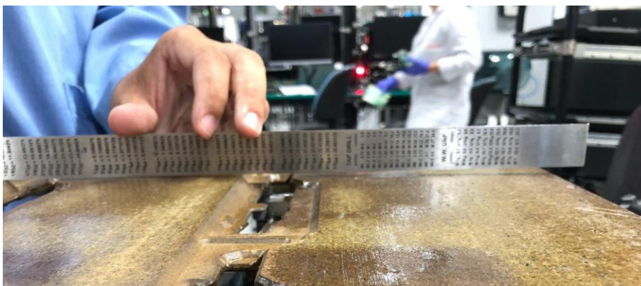
27. ábra. Visszajelzés egy gyártások során elgörbült keretről (saját készítés)
