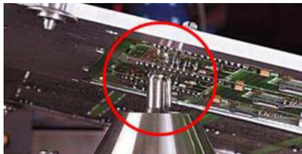
6. ábra. Pontszerű szelektív forrasztás [1]
