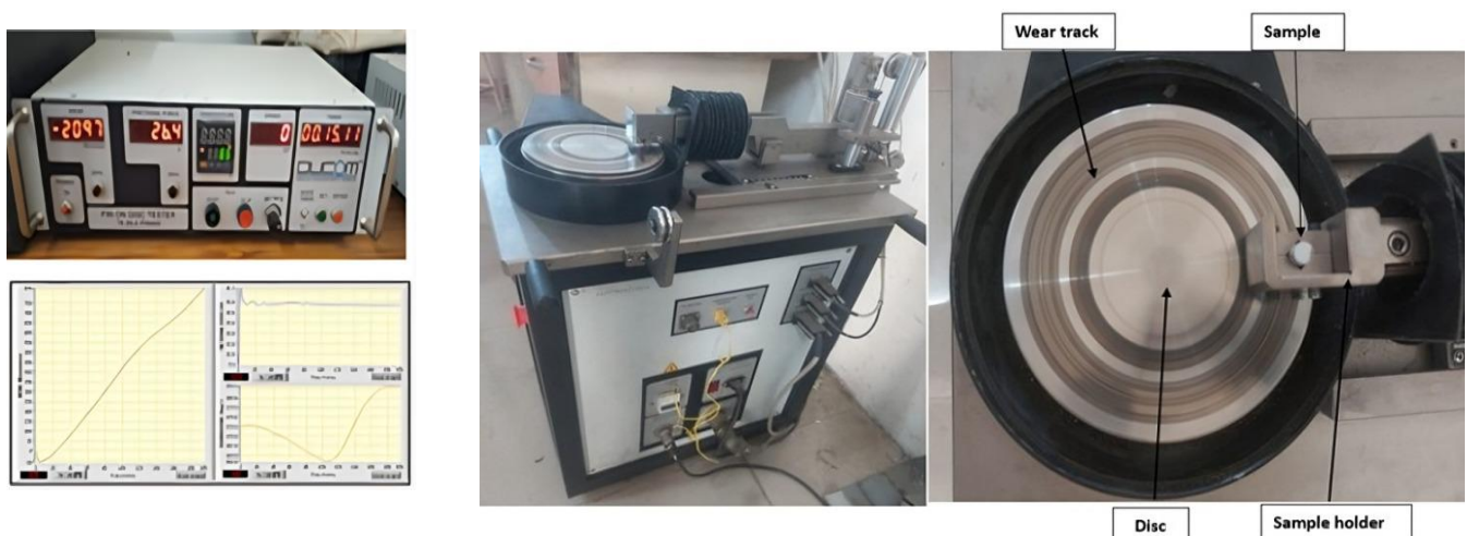
Figure 1. Actual pin-on-disc test setup.
