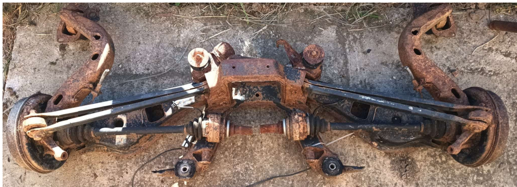
26. ábra BMW E36 hátsó bölcső differenciálmű nélkül (saját, bontott alkatrész)
