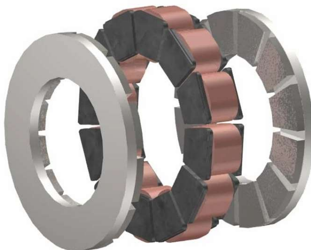
3. ábra Egy állórész két forgórész között [18]
