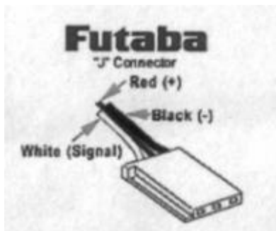
3.12. ábra – Szervók általános csatlakozójának felépítése
