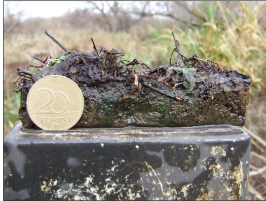
75. ábra. A Horgony mintaterület sarlólaposában elhelyezett üledécsapda alsó szintjében felhalmozódott növénytörmelékkal átszótt üledék az 5. begyűjtés során.
