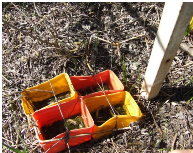
37. ábra. A jég nyomása következtében 45 cm-el mélyebbre került üledékfogók (az alsó eredetileg 10 cm magasan lévő dobozok teljesen megsemmisültek, azoknak csak az eldeformálódott kerete látszik).
