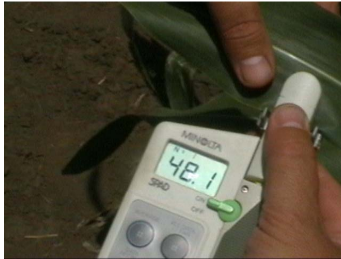
4. ábra: SPAD-502 klorofillmérő készülék
