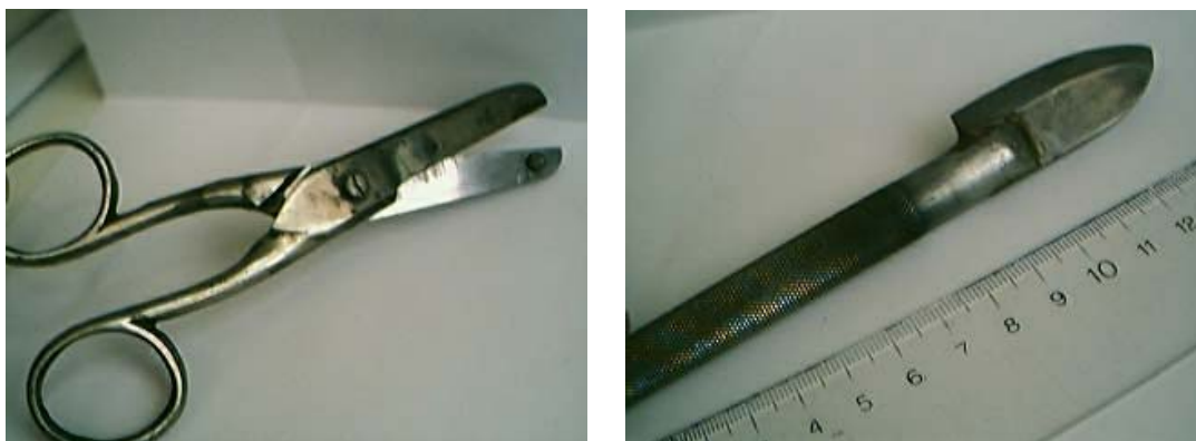
1. ábra: A mintavétel eszközei: tantál-karbid élű olló és wolfram-karbid pengéjű szike
