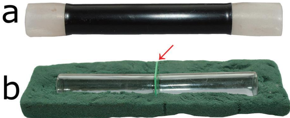
12. ábra: A bátorság tesztekhez (a) valamint az agresszió tesztekhez (b) használt kísérleti csövek felépítése A nyíl a két üvegcső közti elválasztólapot jelöli.
