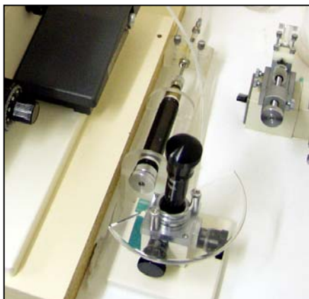
42. ábra: Hidraulikus vezérlő és aspirátor egység
