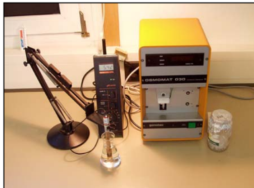
13. ábra: Oldatkészítő munkaasztal 14. ábra: pH és ozmolaritásmérő műszerek
