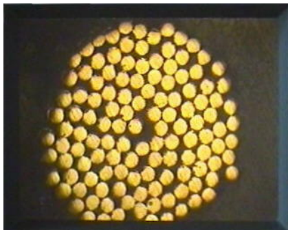
90. ábra. 128 db, 100 \mu\text{m} átmérőjű egységből felépülő 45°-os hegyes MEA, foto optikával nagyítva Fotó: Saját felvétel
