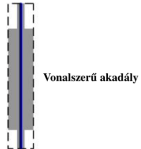
2.5. ábra Nagyfeszültségű távvezetékoszlop, amely vonalszerű akadályt képez az adatbázisokban (EUROCONTROL Terrain and Obstacle Data Manual 2015)
