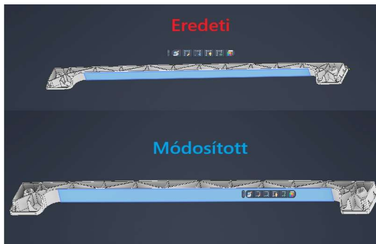
20. ábra. A hátoldali falvastagság módosításának összehasonlítása az eredeti és a módosított kialakításon. Forrás: saját készítésű kép.
