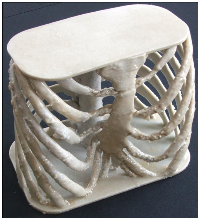
3. ábra Mellkas deformitás megjelenítése binder jetting rendszerű 3D nyomtatással
