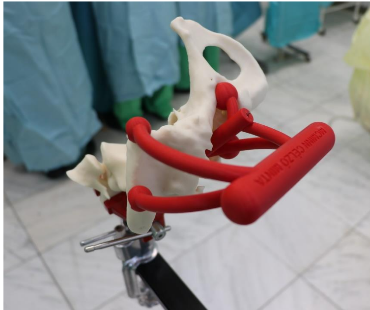
49. ábra ABS alapanyagú, FDM technológiával nyomtatott jobboldali félmedence, a célzóval [112]
