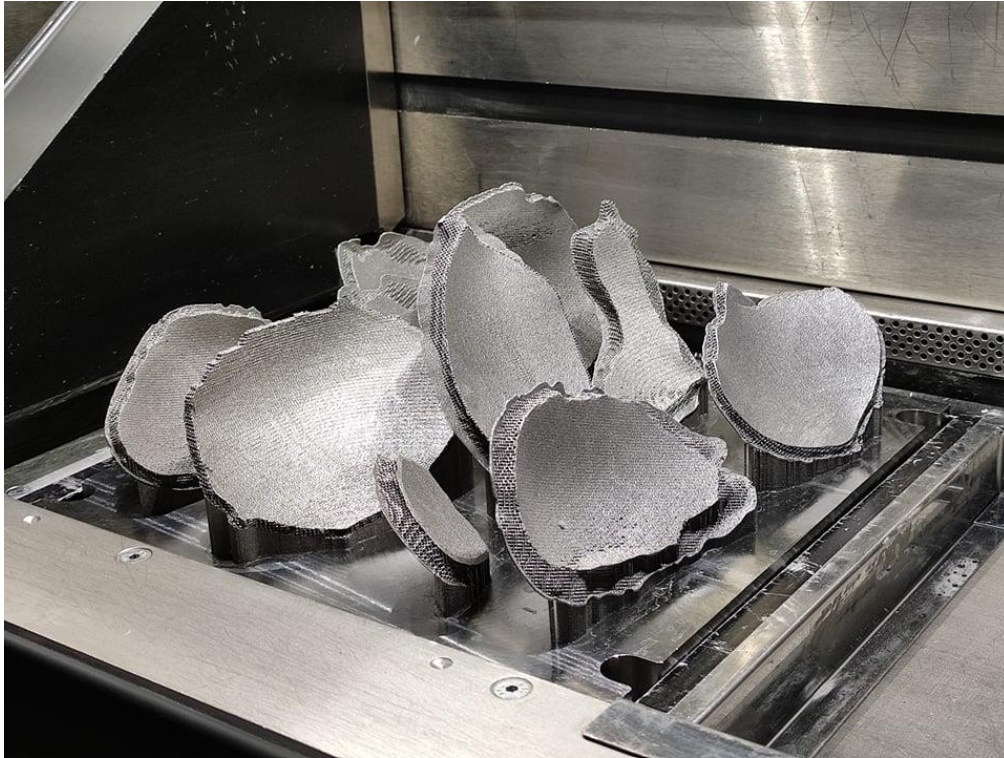
48. ábra Cranioplastica implantátum előgyártmányok a titánnnyomtató nyomtatási terében
