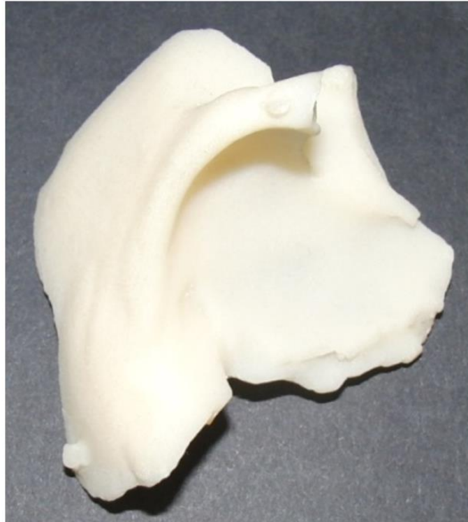
46. ábra Szilikon öntőforma alkalmazásával nyert, beültethető koponyaimplantátum [137]
