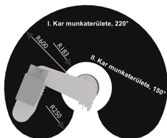
2.5. ábra. A munkaterület és a SCARA robotegység robotkarjaihoz tartozó fizikai paraméterek mérettel.
