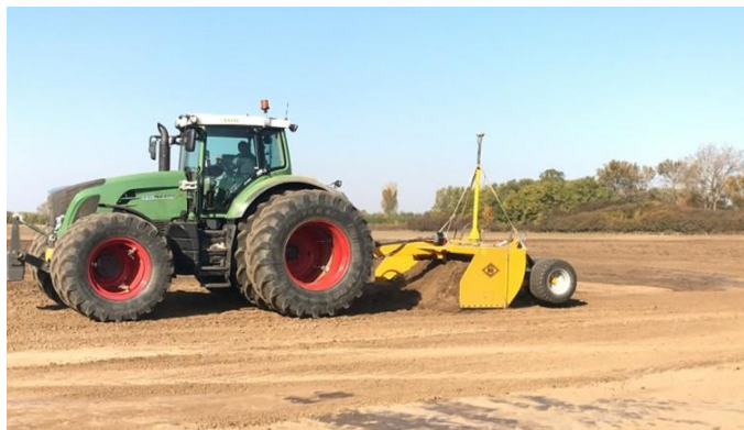
1. ábra: Szkrépezés a kísérleti területen. A nyesőládát egy 287 kW teljesítményű traktor üzemeltette (Forrás: saját fotó)
