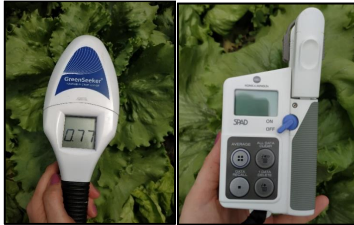
A növényállományon végzett NDVI és SPAD mérése
