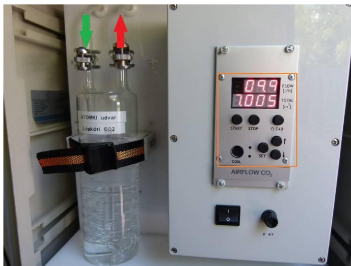
16. ábra: Az ATOMKI-Isotopetch fejlesztésű ^{14}\text{C} mintavevő berendezés a lúgot tartalmazó üvegcspadával és a működtető elektronikával. A nyilak a levegő útját mutatják, a kezelőpanel a jobb oldalon látható
