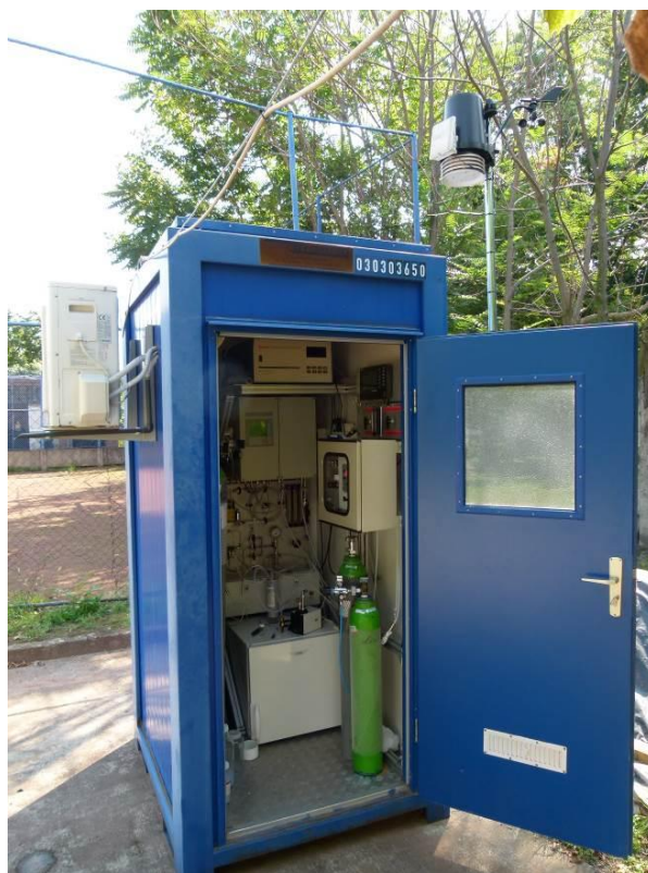
14. ábra: a mobil légköri CO 2 mérő és 14 C mintavevő állomás az ATOMKI udvarán
