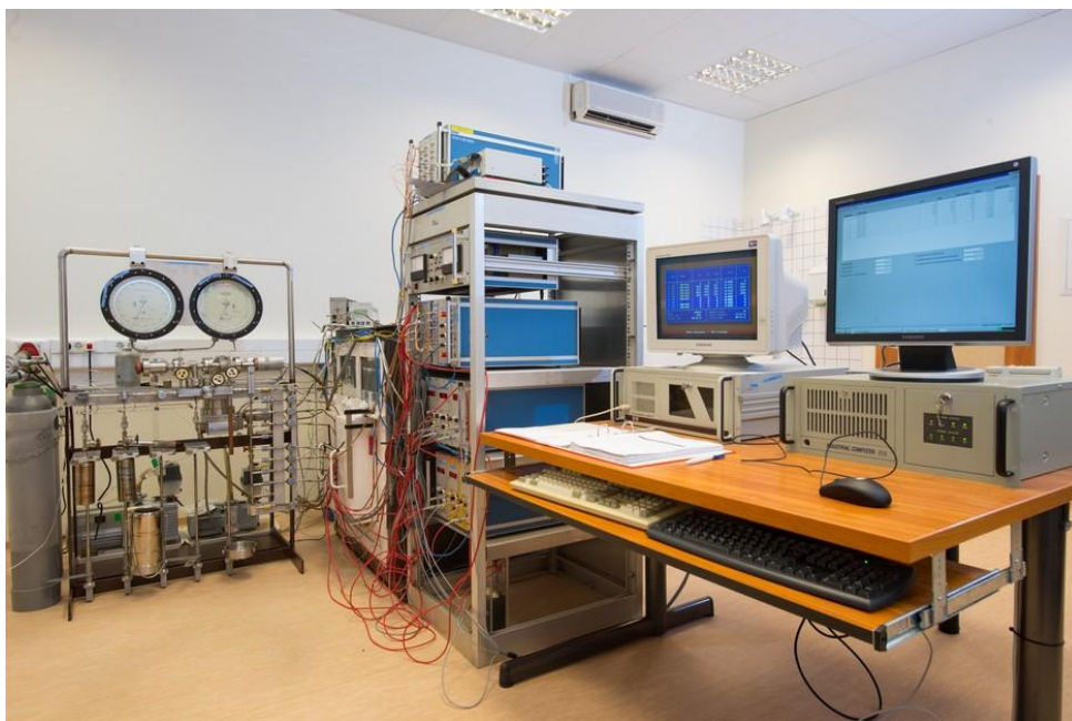
18. ábra. Gázproporcionális mérőműszer a gáztöltő és az adatfeldolgozó rendszerekkel az ATOMKI-ban
