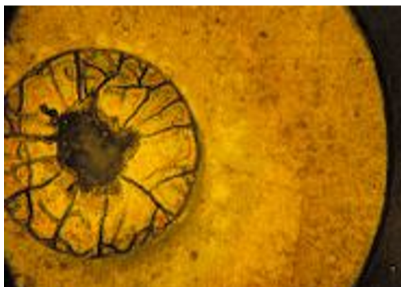
2. ábra. Cd huzal Ni réteggel 565 K-en hőkezelve 500 percig. A \gamma fázisban sugár irányú repedések keletkeztek a felépült mechanikai feszültség hatására [55].
