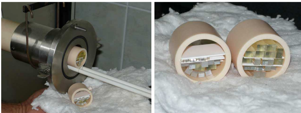
5.9. ábra. Még meleg ( 300\text{ }^{\circ}\text{C} ) minták kivétele a kemencéből és pihentetése Al_2O_3 vattapárnán.
