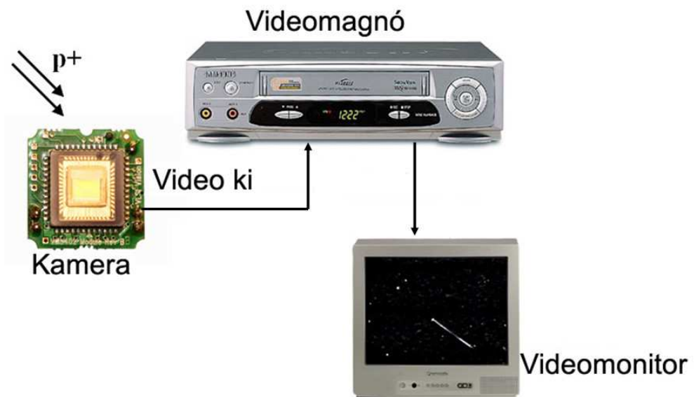
3.6. ábra. A besugárzásnál használt, VHS videomagnetofonra alapozott analóg jelrögzítő összeállítás.
