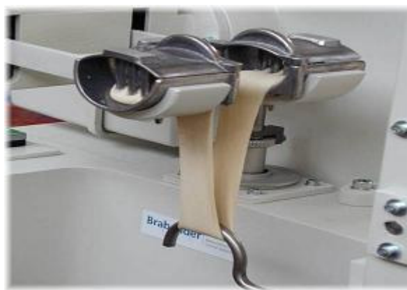
2. kép: Brabender extenzográf tésztanyújtó szerkezete
