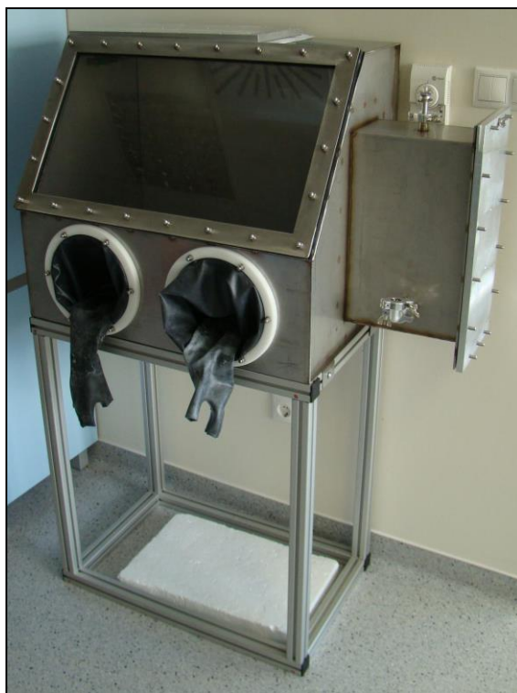
28. ábra: A karbonát minták előkészítésre épített kesztyűdoboz
