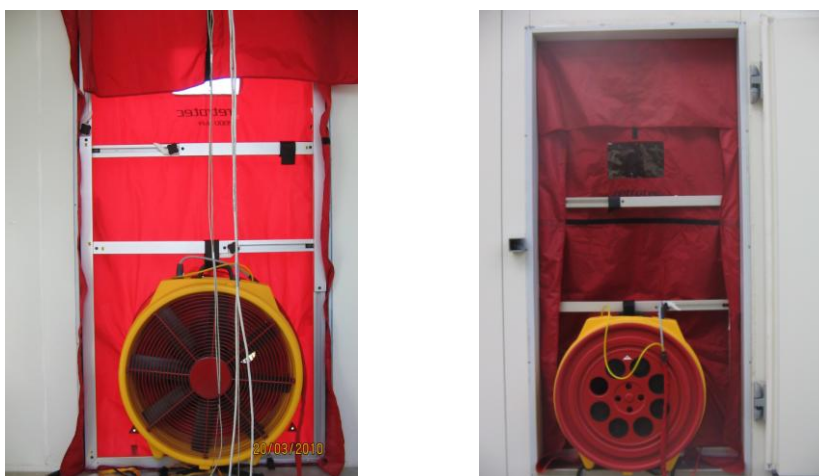
4.52. ábra Teszt helyiség légtömörségének mérése
