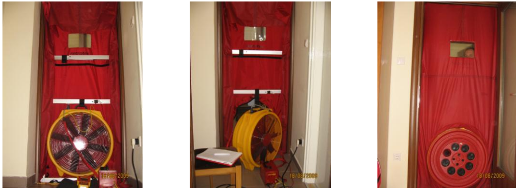
4.23. ábra Légtömörség mérés RETROTEC 3000 blower door készülékkel
