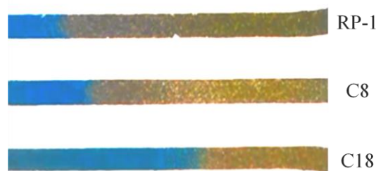
3. ábra Ételfesték keverék egyidejű elválasztása három különböző kromatográfias tölteten.
