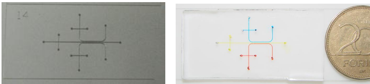
1. ábra A három különálló csatornarendszert tartalmazó mikrofluidikai csip készítéséhez használt öntőforma (bal oldali kép) és a különböző festékekkel megtöltött üvegre ragasztott mikrocsip (jobb oldali kép).
