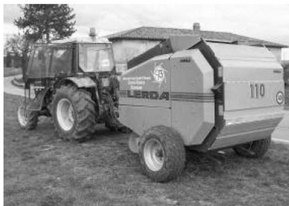
1. ábra: Venyigbálázás körbálázóval
