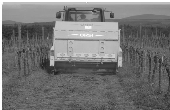
8. ábra: Járvaaprító munka közben egyenetlen felszínen
