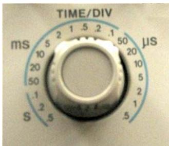
9. ábra: időosztás-állító tekerőgomb egy analóg oszcilloszkópon
