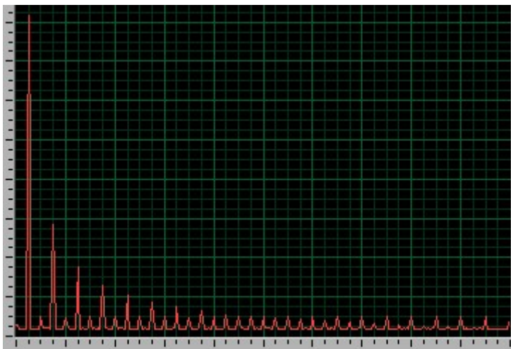
29. ábra: Egy zajos jel frekvenciaspektruma
