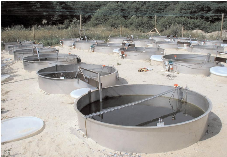
3. kép: A globális klímaváltozás és az alternatív stabil állapotok sekély tavakra gyakorolt hatásait modellező kísérleti létesítmény a NERI-ben, Dánia (Forrás: Liboriussen et al., 2005)
