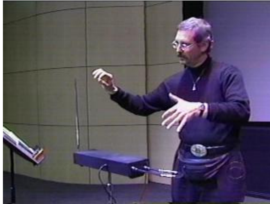
3.6 ábra. A theremin két kézzel működtethető. A kezek pozícióját figyeli a vertikális és horizontális tengely mentén. Az egyik kézzel a hangerő, a másikkal a hangmagasság vezérelhető.
