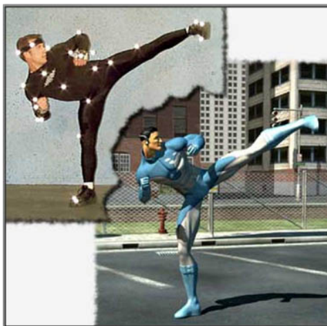
3.3 ábra. A motion capture eljáráshoz használt érzékelőkkel ellátott ruha
