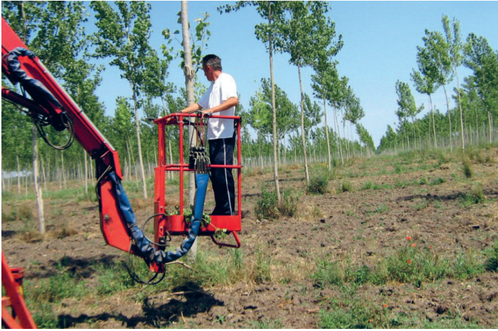
19. kép: Emelőkosaras kézi nyesés pneumatikus ollóval Veszprém megyei nemes nyár ültetvényben (Fotó: Nagy I.)
