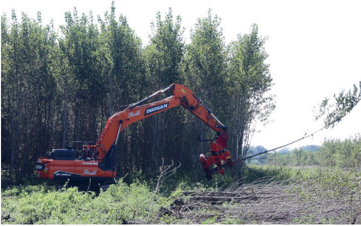
15. kép: Sarjaztatásos ültetvény betakarítása döntő-rakásoló adapterrel felszerelt géppel (Fotó: Benke A.)
