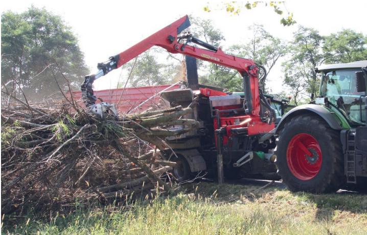
16. kép: A terület szélére rakásolt faanyag aprítása nagyteljesítményű aprítógéppel (Fotó: Benke A.)
