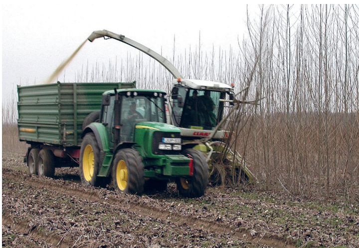
13. kép: Sarjzattasos energetikai ültetvény betakarítása önjáró aprítóval (Fotó: Benke A.)
