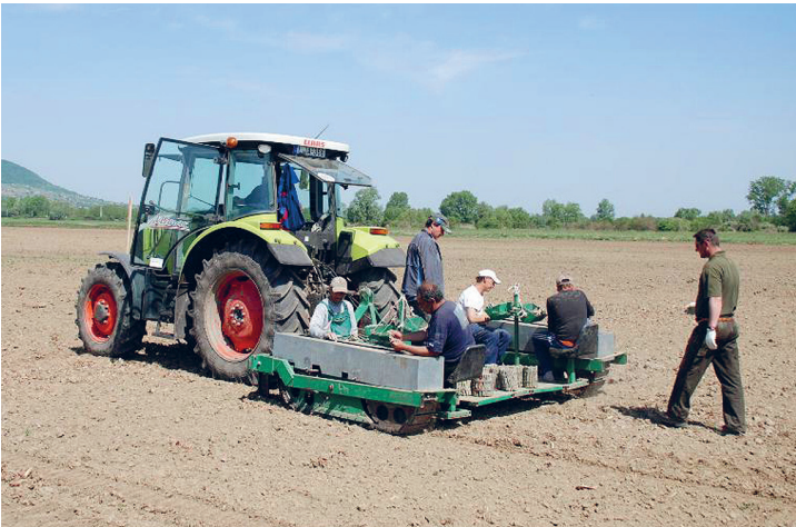
10. kép: Nemesnyár sarjzatatásos típusú energetikai ültetvény dugványozása traktorral vontatott kétsoros dugványozógéppel (Fotó: Benke A.)
