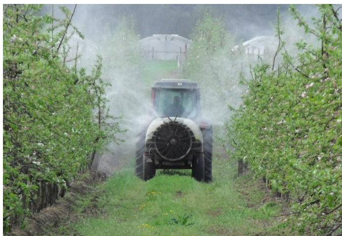
70. melléklet: Központi szóró szerkezettel szerelt permetezőgép (saját felvétel)
