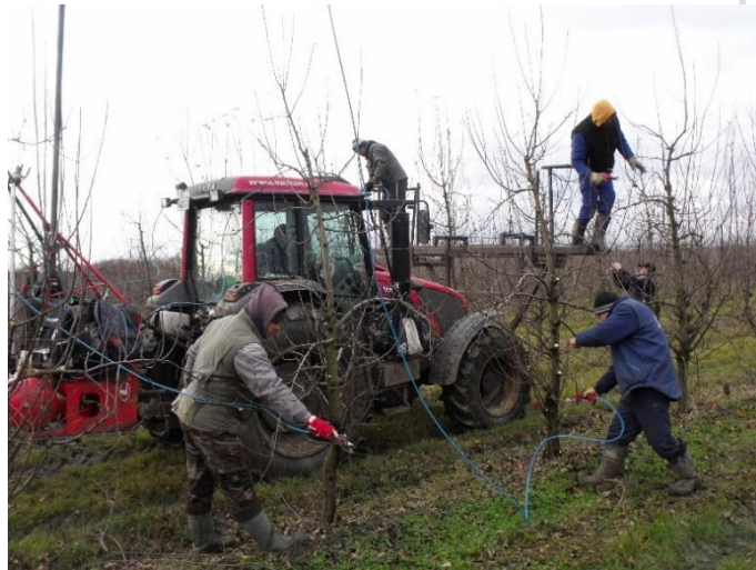
65. melléklet: Traktorról hajtott pneumatikus metszőolló (saját felvétel)
