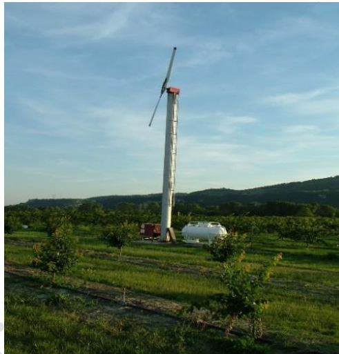
11. melléklet: Légkeveréses fagyvédelem (saját felvétel)
