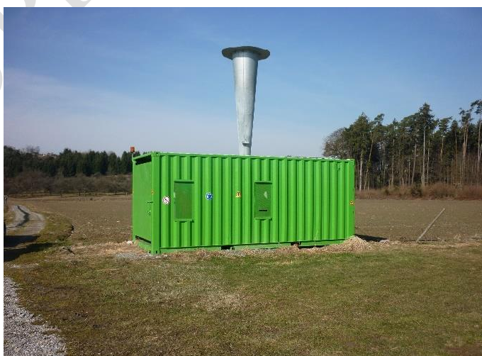
18. melléklet: Jégvédelmi ágyú (Fotó: Apáti Ferenc)
