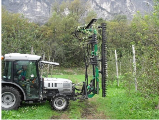
67. melléklet: Alternálókéses síkfalmetsző (saját felvétel)
