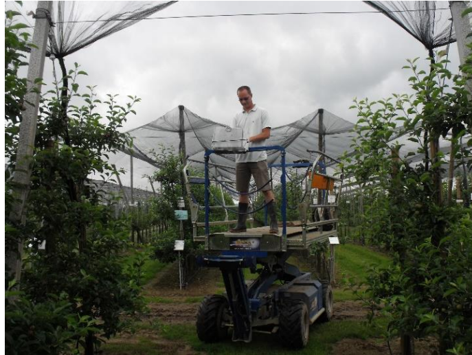
73. melléklet: Önjáró munkaállvány (saját felvétel)
