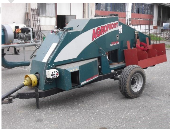
15. melléklet: Frostbuster fagyvédelmi gép (saját felvétel)
