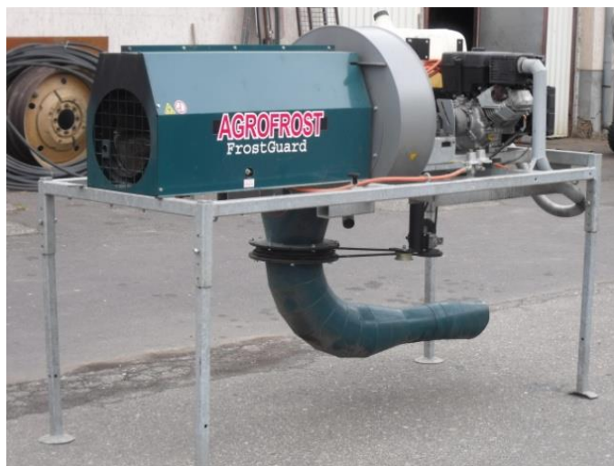
16. melléklet: Frostguard fagyvédelmi gép (saját felvétel)
