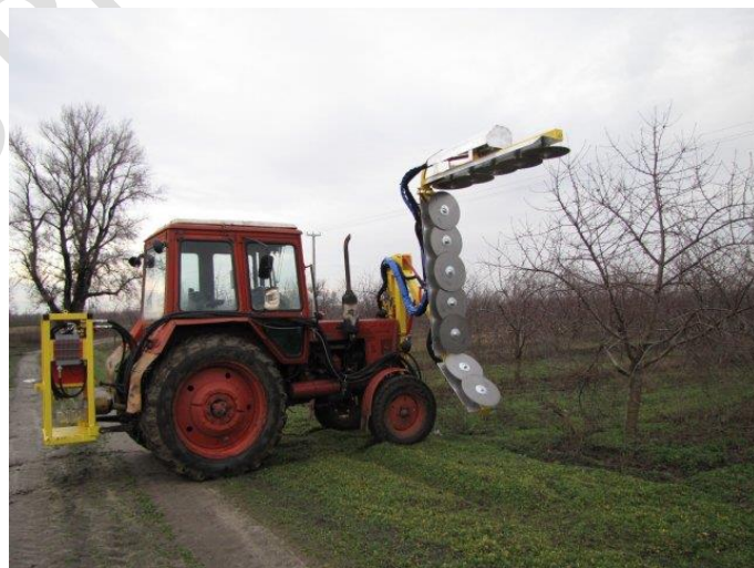
66. melléklet: Körkéses síkfalmetsző és tetejező (saját felvétel)
