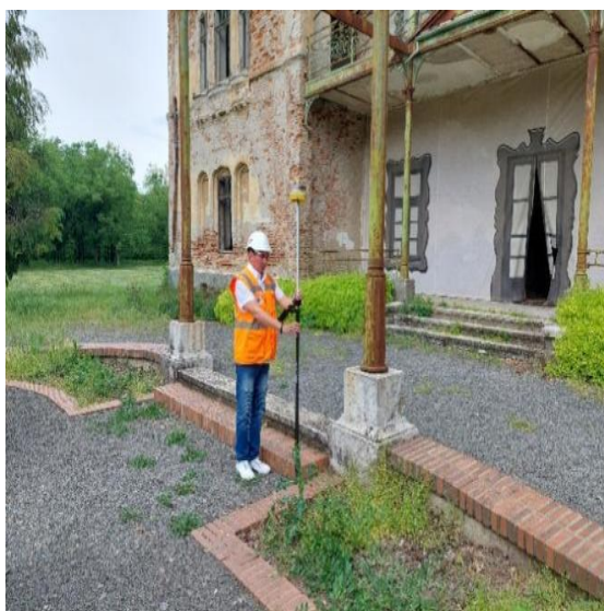
59. ábra: A kastély felmérése GPS eszközzel (forrás: saját fotó, saját szerkesztés 2023)
