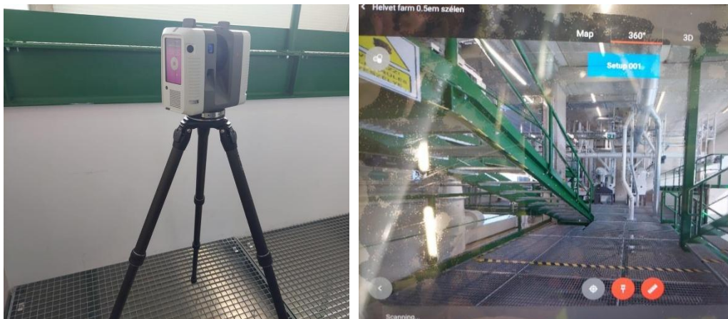
64. ábra: Nagypontosságú ipari épület szkennelés a Helvét Farm üzemépületen (forrás: saját fotó és szerkesztés)
