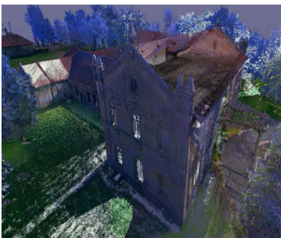
61. ábra: A fotó és a szkennerral felmért déli homlokzat pontfelhője (saját szerkesztés 2024)
