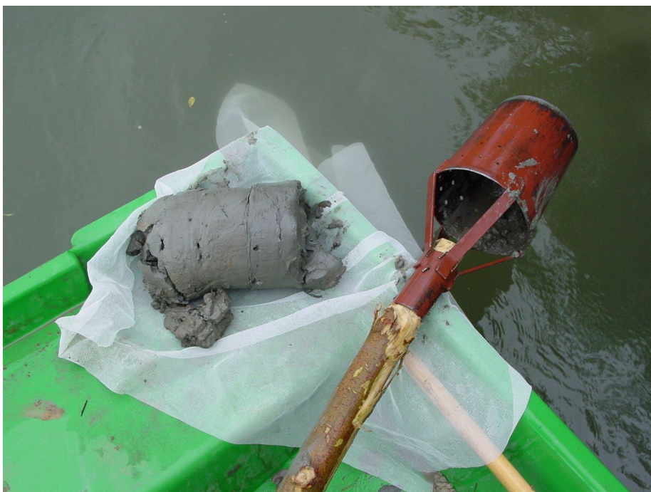
6. ábra Báger (nyélre erősített lefelé keskenyedő, 25 cm átmérőjű és 30 cm magas hiányos hengerkúp) és a bágerminta
