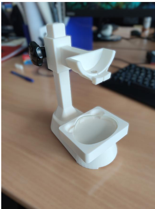
6. ábra A lencseméréshez használt eszköz egy háromszög alakú lencsével
