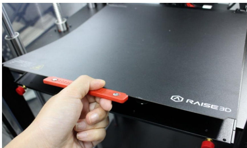
23. ábra A lemez kivétele a tisztításhoz [20]
