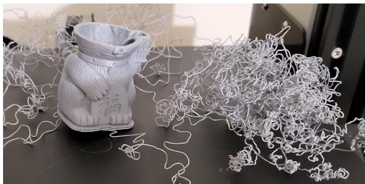
32. ábra Példa nyomtatás közbeni felválásra [22]
