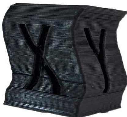
34. ábra Példa elcsúszott rétegekre [22]
