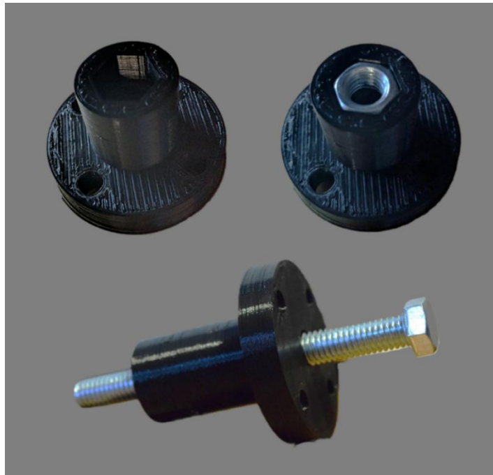
20. ábra Példa nyomtatás közbeni anya beillesztésre [16]
