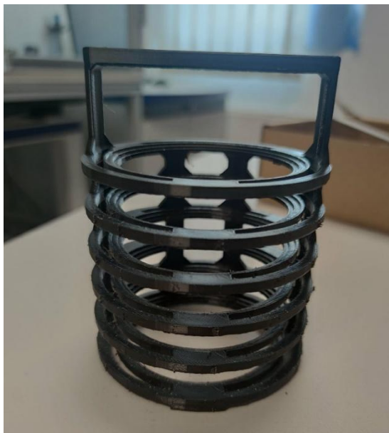
4. ábra A lencsék teszteléséhez használt merítőkosár
