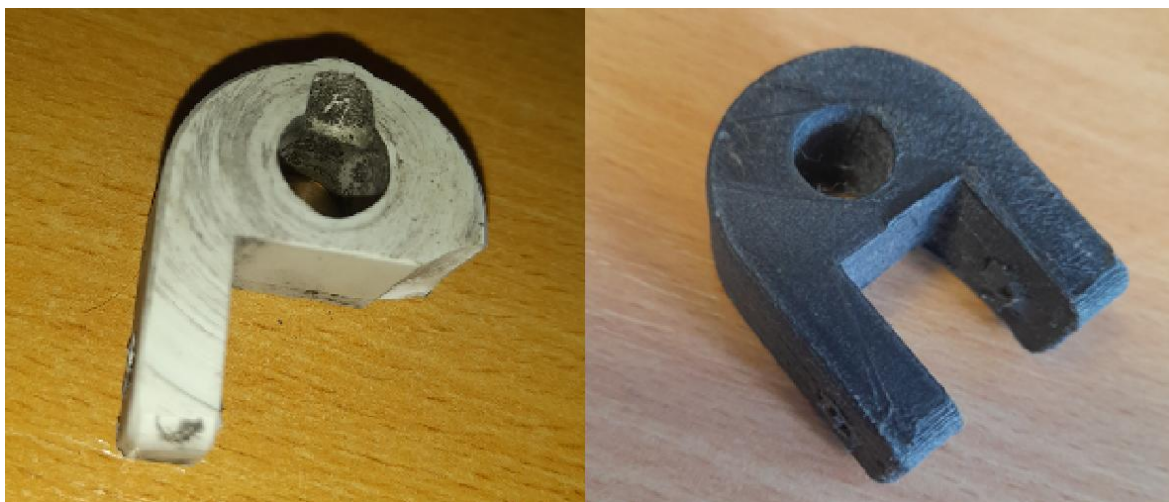
5. ábra A fotocellás ajtó eltört eredeti alkatrésze (bal oldal) és annak 3D nyomtatott replikája (jobb oldal)
