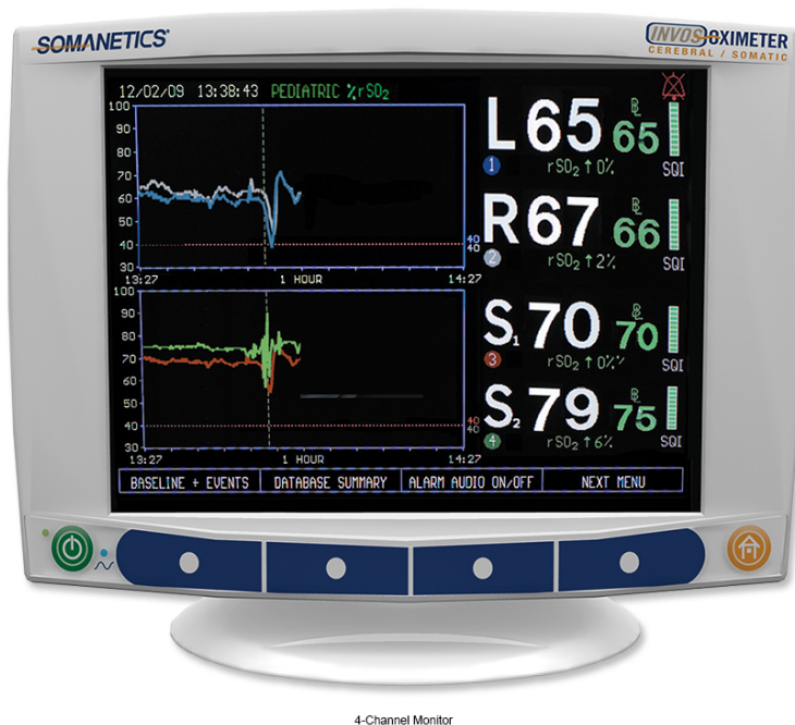
11.ábra: Regionális agyi oxigén szaturáció mérésére alkalmas INVOS™ készülék
