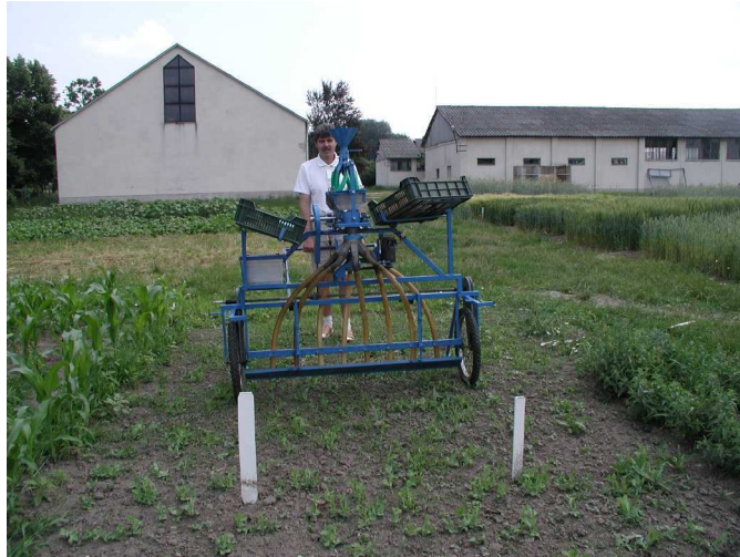
51. ábra. A kísérleti parcella-műtrágyaszóró gép kézzel tolt változata
