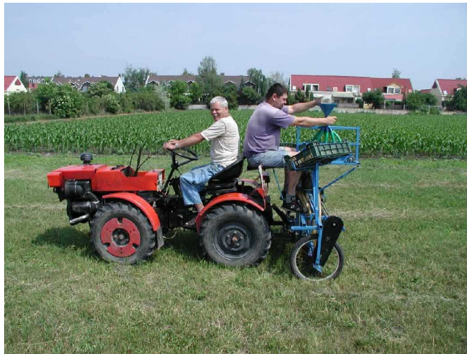
50. ábra. A kísérleti parcella-műtrágyaszóró gép traktorrally vontatott változata
