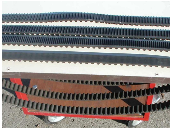
22. ábra. Különböző fogosztású fogazott lapos szíjak a kísérleti modellhez
