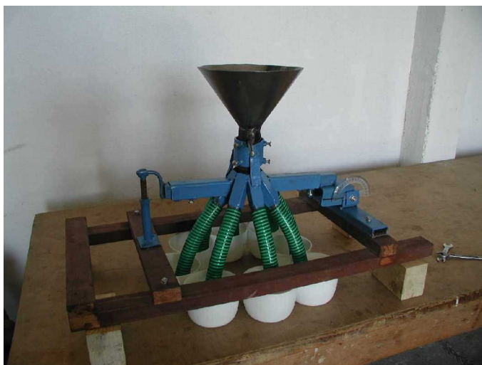
17. ábra. Vizsgálópad a gravitációs osztókúp ellenőrzéséhez
