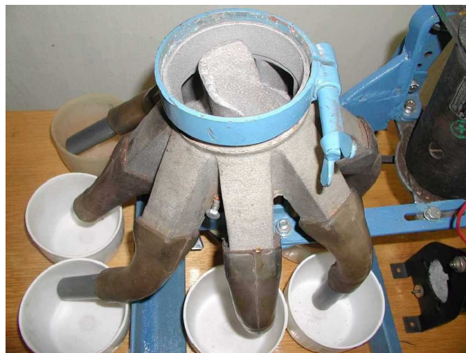
18. ábra. A rotációs szétosztó felépítése
