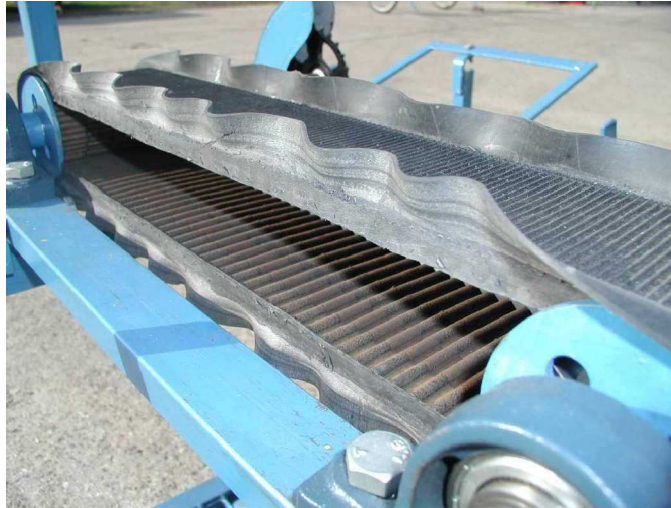
46. ábra. A két oldalon fogazott heveder
