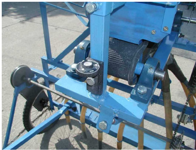
45. ábra. Vízszintmérő a csapágytartó kereten
