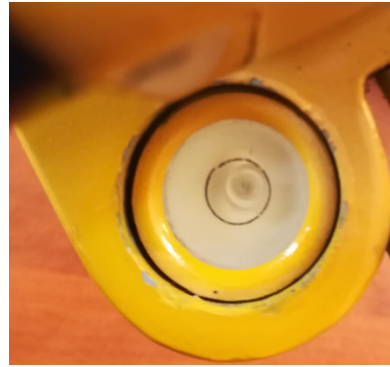
4.2. ábra. NI-E3 szintező szelencés libellája
