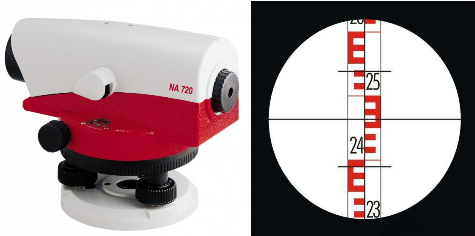
4.8. ábra. Kompenzátoros szintező műszer és egy cm beosztású szintezőléc
