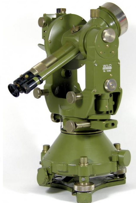
4.5. ábra. A teodolit szerkezete és egy Wild T3 teodolit
