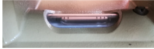
4.1. ábra. Leica TC 1010 mérőállomás csöves libellája
