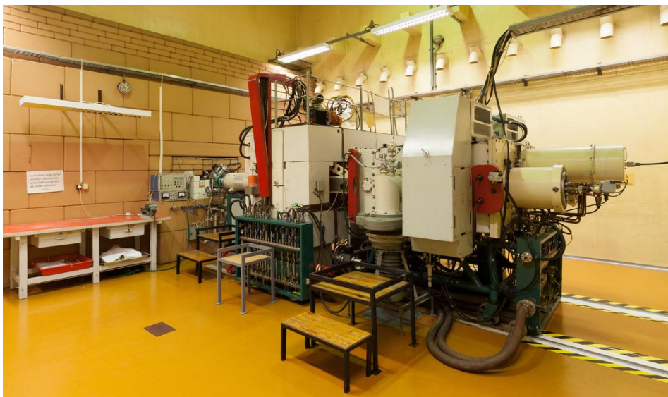
9. ábra Az Atomki K = 20 ciklotron gyorsítójának fényképe.
