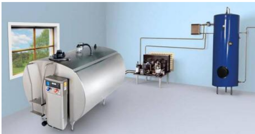
8. ábra: A hővisszanyerős tejhűtési rendszer vázlata
