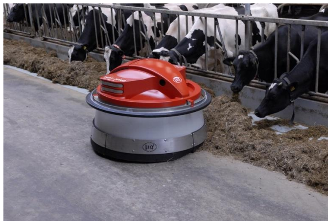
12. ábra: Takarmány feltoló robot munkája az etetőasztalon
