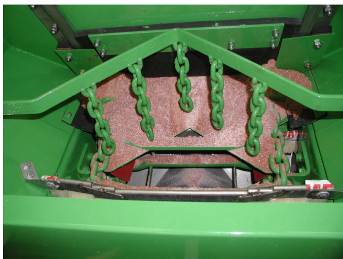
7. ábra. A fenéklemez kivágása az osztató láncokkal
