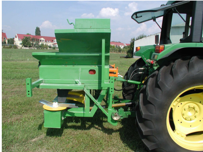
4. ábra. Függesztett, röpitőtárcsás kísérleti műtrágyaszóró gép
