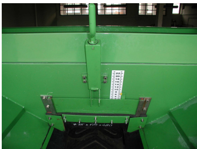
8. ábra. Résállító szerkezet a beállító skálával
