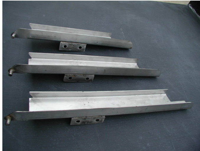
13. ábra. Eltérő hosszúságú lapátok
