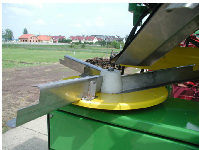
12. ábra. Háromlapátos szóró szerkezet
