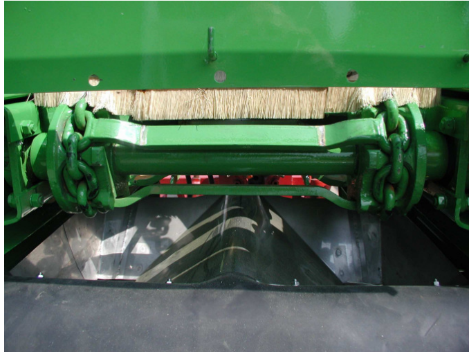
9. ábra. A műtrágyaelosztó szerkezet
