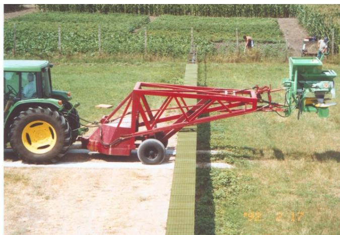
15. ábra. 50 m széles mérőpálya függesztett gépek vizsgálatához
