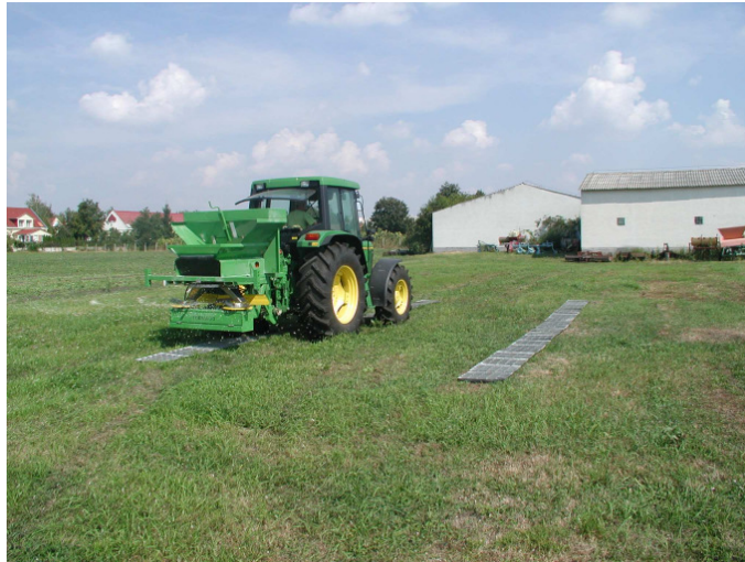
19. ábra. Hosszirányú szórás egyenlőtlenség mérés
