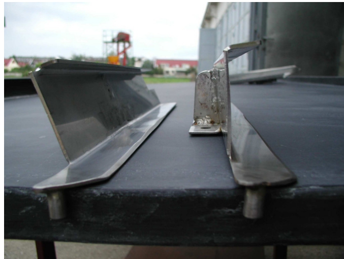
14. ábra. Eltérő hátdőlésű lapátok
