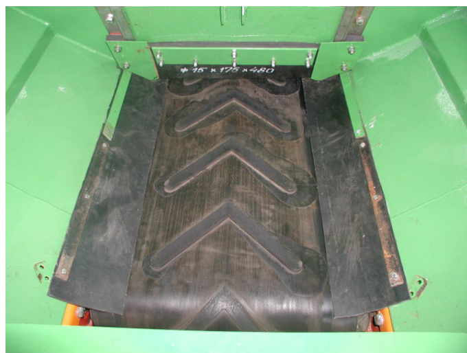
6. ábra. Szalagos adagolószerkezet
