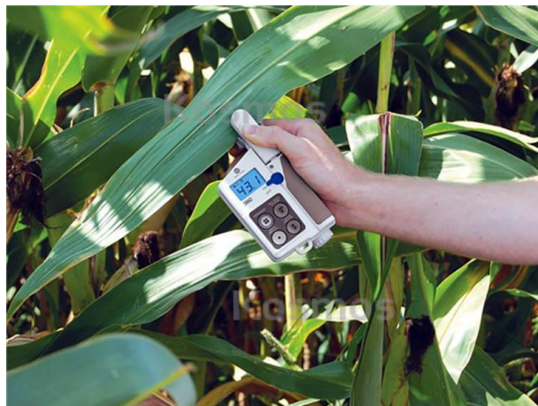
4. ábra: SPAD-502 relatív klorofilltartalom mérő műszer
