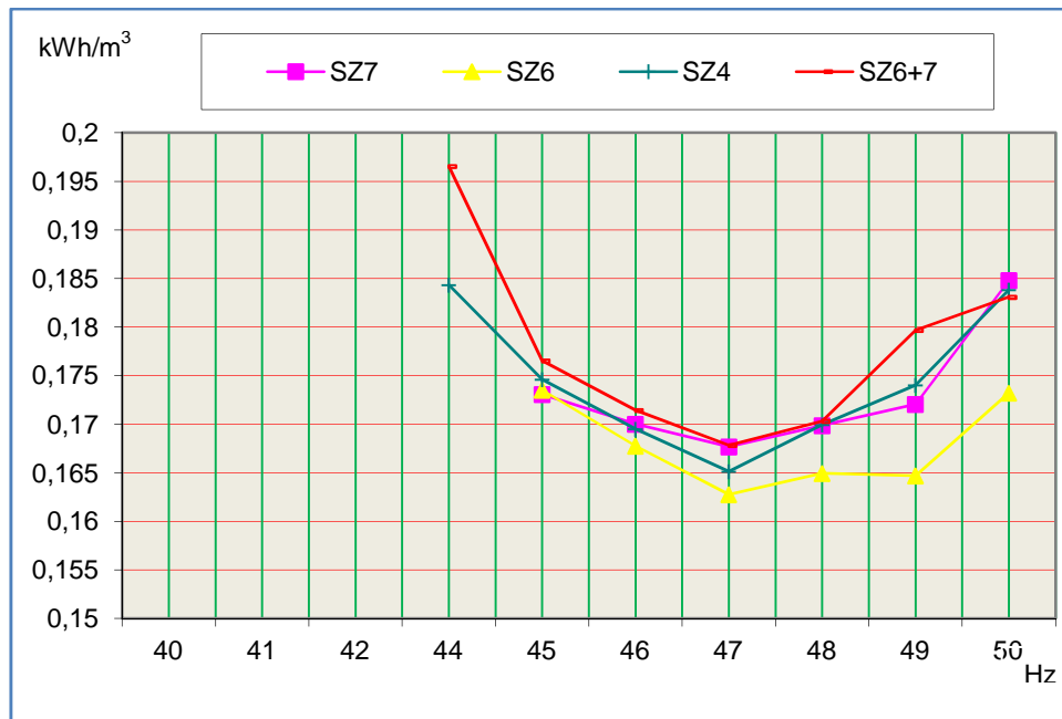
10. ábra: SZ4, SZ6, SZ7 jelű hálózati szivattyúk energiahatékonysága 44-50 Hz motor terhelés esetén
