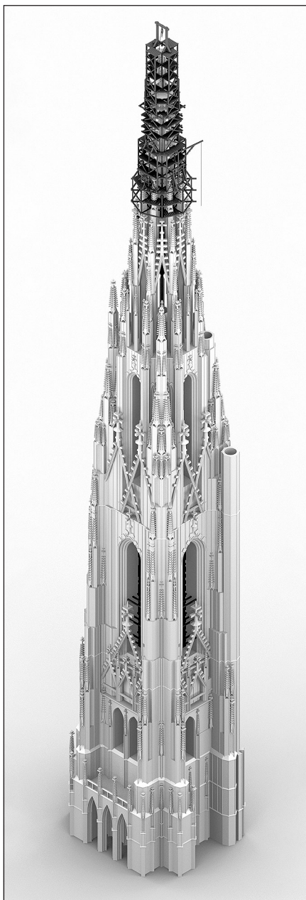
41. kép – Toronyépítés rekonstrukciója, utolsó szakasz: a toronysisak felső részének építése
