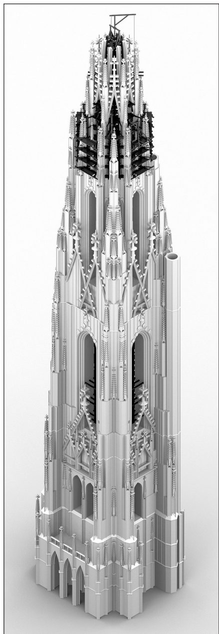
40. kép – Toronyépítés rekonstrukciója, negyedik szakasz: a toronysisak alsó részének építése
