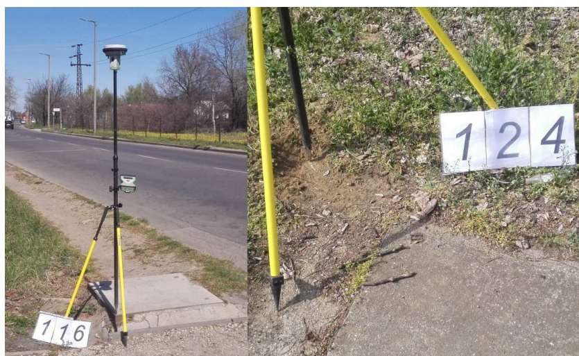
18. ábra I. rendű (116-os) referenciapont egy távoli és egy II. rendű (124-es) referenciapont egy közeli felvételen (saját fotó)
